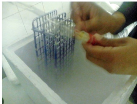
FIGURA IX-11. Enfriamiento con vapores de nitrógeno antes del descenso final de temperatura de congelación. (Silva, 2017).
